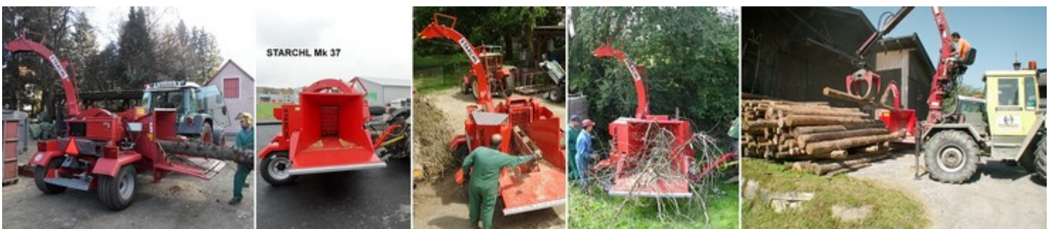
STARCHL Traktorhacker Mk 37, hand- oder kranbeschickt mit versch. Ausgangsmaterialien
