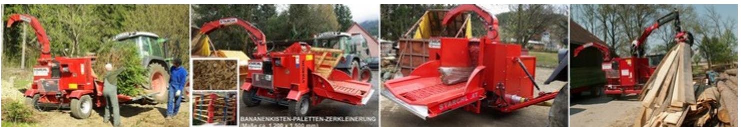
STARCHL Trommelhacker Mk 50-S im Hackeinsatz (Wipfel-, Stamm-, Paletten- und Spreißelzerkleinerung)
