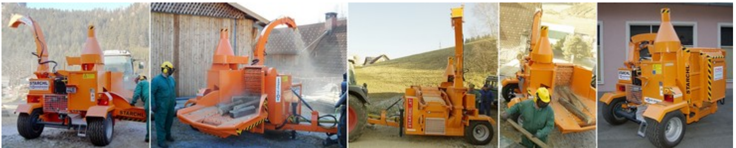
STARCHL Mobilhacker Mk 62-S mit Untenanhängung für Schweizer Lohndienstleister, Link: http://www.lindehof.ch/offenetuere/content/024_large.html
